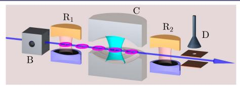
Les photons piégés entre les deux miroirs de la cavité C sont mesurés avec des atomes (les petits anneaux couleur rose foncé) sortant de B. Les atomes traversent l'un après l'autre la cavité C. Ils sont manipulés individuellement avant et après leur passage dans la cavité dans  $R_1$  et  $R_2$ . Ils sont mesurés par le détecteur D soit dans un état de basse énergie  $|g\rangle$  soit dans un état de forte énergie  $|e\rangle$ .
