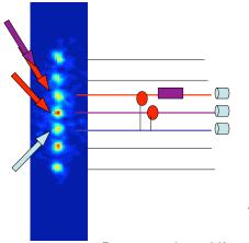
Des impulsions laser appliqués séquentiellement aux ions de la chaîne réalisent des portes à un bit et des portes à deux bits. La détection par fluorescence (éventuellement précédée par une rotation du bit) extrait l'information du système.
