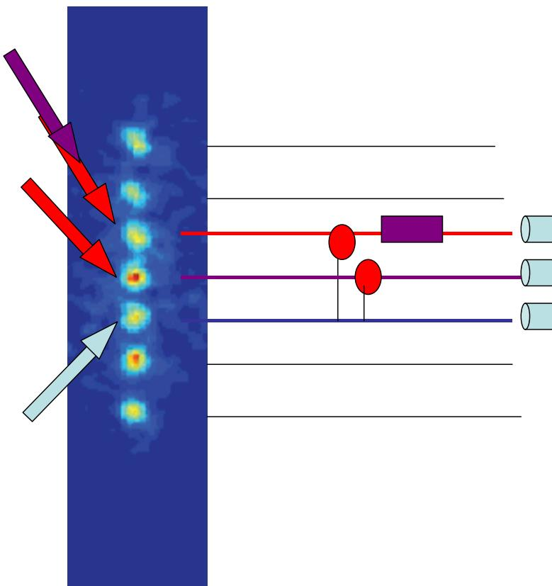
*Des impulsions laser appliqués séquentiellement aux ions de la chaîne réalisent des portes à un bit et des portes à deux bits. La détection par fluorescence (éventuellement précédée par une rotation du bit) extrait l'information du système.*
